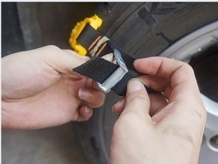
1. Rodee los neumáticos por los dos lados y presione las hebillas de fijación, el cinturón cruza de arriba a abajo
