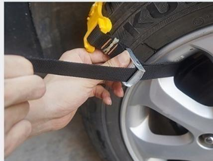
2. Rellene las juntas debajo de las hebillas de fijación y abroche la correa
